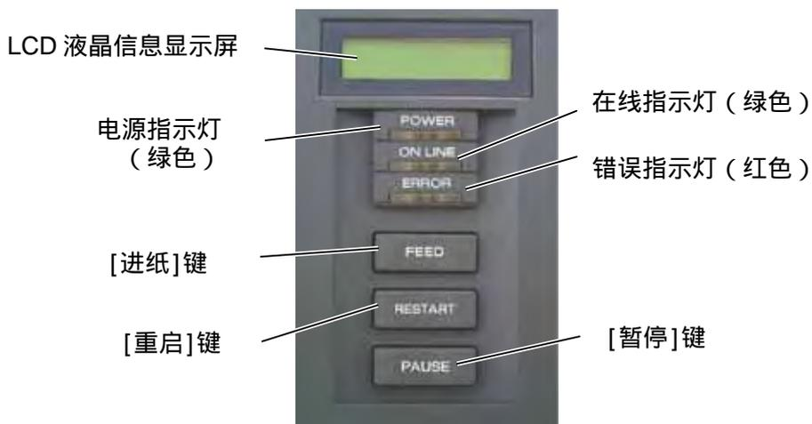
LCD 液晶信息显示屏，以数字字符和符号的方式显示打印机即时的状态。最多能显示两行 32 个字符。
