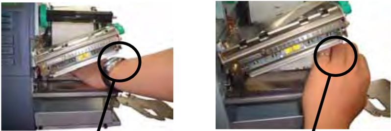
注意不要让金属或手表表面的玻璃部分接触打印头边缘。
