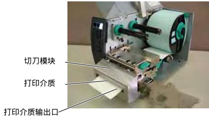
13. 如果加载的打印介质是热敏型的介质（表面经过化学处理的），加载打印介质程序就已经完成。关上碳带挡板，即将打印头拧置于 Lock 位置。然后，关上机箱上盖。如果是热转印介质，也有必要安装碳带。参考 2.8 节——安装碳带。
