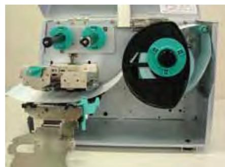
8. 让介质穿过介质固定夹，调节固定夹直至关键介质宽度，旋紧固定螺丝。
