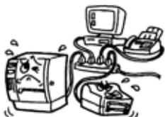
如果此设备和其他大耗电量的设备使用同一个插座，则在使用这些设备的时候将会引起电流的大幅度波动。一定要给此设备提供一个单独的插座，否则会引起火灾或者电击。
