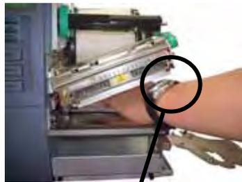
注意不要让手表表面的玻璃部分接触打印头边缘。
