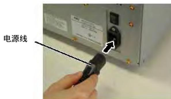
3. 把电源线的另一端插到接地的插口里，如下图所示。
