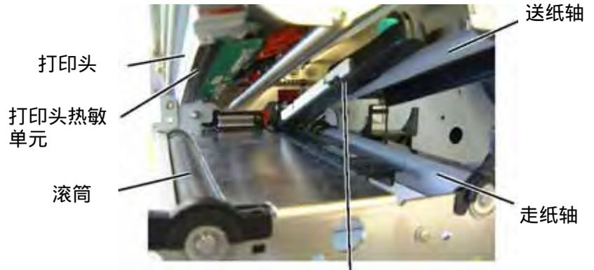
黑标探测器/间隙探测器
